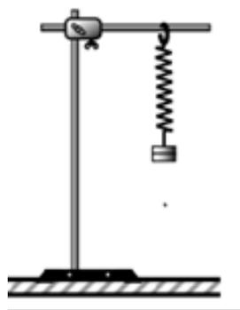
**Figura 1.** Dispositivo para explorar la ley de Hooke
