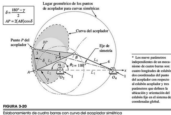
**Figura 1.** Herramientas trigonométricas en el modelo de un acoplador. Norton, 2013, p. 90
