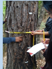
Figura 7. Medida del contorno para calcular el diámetro a la altura de pecho
