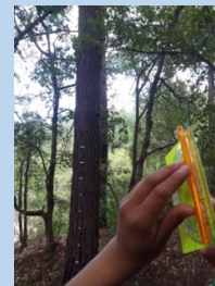
Figura 8. Medida del ángulo para determinar la altura
