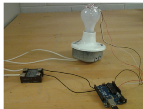
Figura 4. Sistema de control de temperatura de un foco. (Mendoza y Cordero, 2018)
